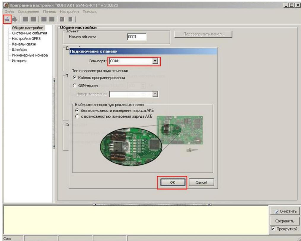
8. После подключения оставшиеся иконки в окне становятся активными. В нижней части окна появляется COM-порт, по которому производится подключение и версия прибора.
