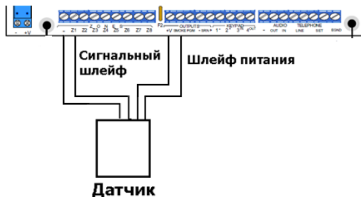
Рисунок 15 - Подключение четырехпроводного датчика со сбросом питания
