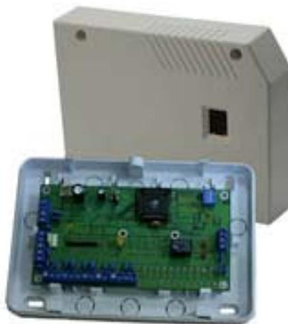
Рисунок 48 - Внешний вид расширителя I/O-8N
