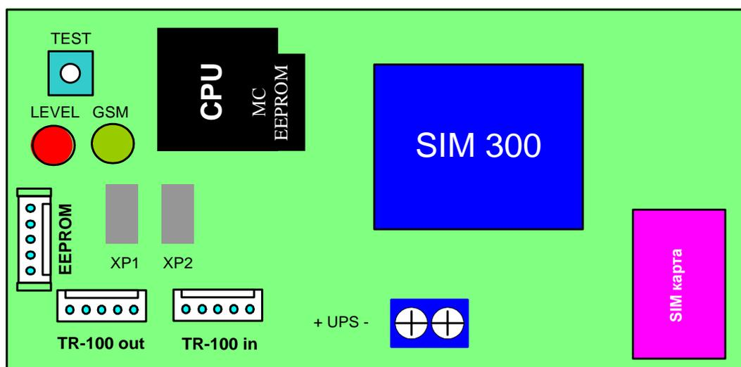
Рисунок 1 - Общий вид платы передатчика TP-100 GSM
