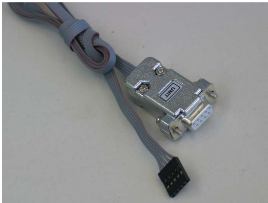
Рисунок 23 - Внешний вид кабеля программатора UNIT-NEWTR
