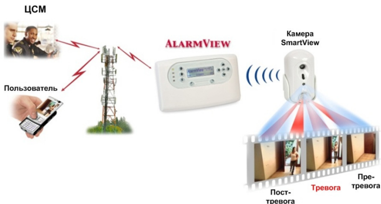
Рис 2. Визуальная проверка AlarmView
