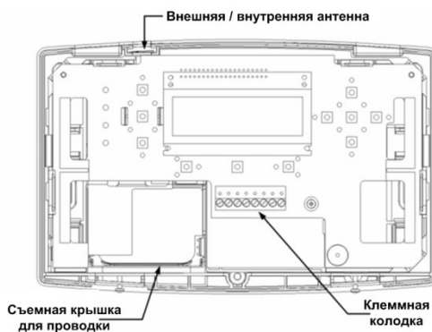
Рис 28. Плата контрольной панели
