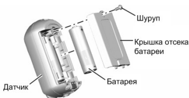
Рис 39. Замена батарей в SmartView
