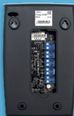
entrada para antena GSM externa
