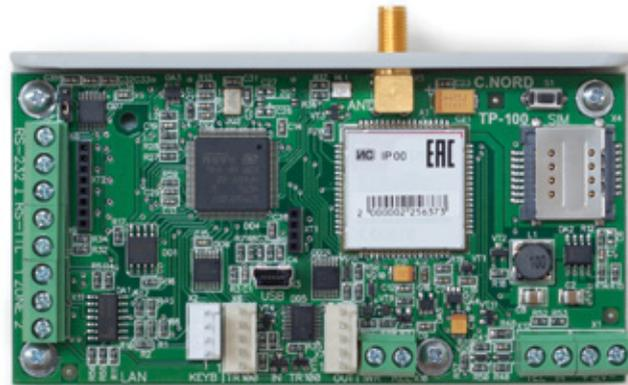
Dispositivo integrable. Soyuz PCB está diseñado en forma de placa montada en una carcasa angular de plástico lo que permite montar este dispositivo en cualquier gabinete. 12V, 0.5 A
